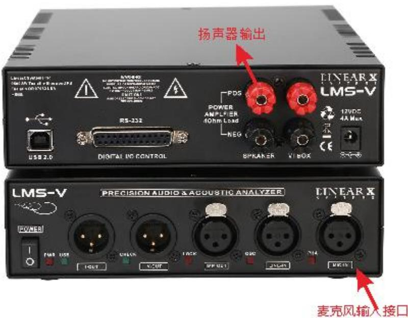
首先确认接线正常，然后点击载入须测量的喇叭阻抗对应的文档，如：4 欧姆喇叭测试首先载入频响测试-4-ohm.set 文件打开，选择曲线库，选择我们要保存的曲线图层，然后点红色按钮开始测试或（F9 键）
