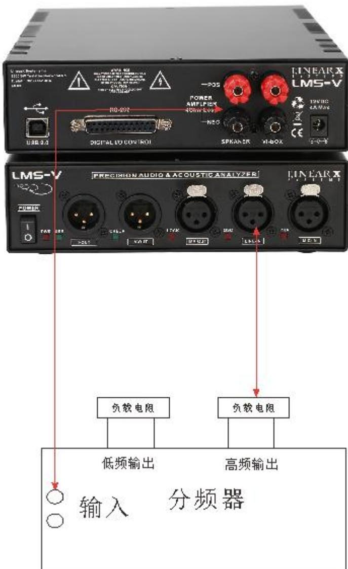
按照分频器测试链接线图链接，使用水泥电阻做负载，进入 LMS 主界面，载入快速设定好的
